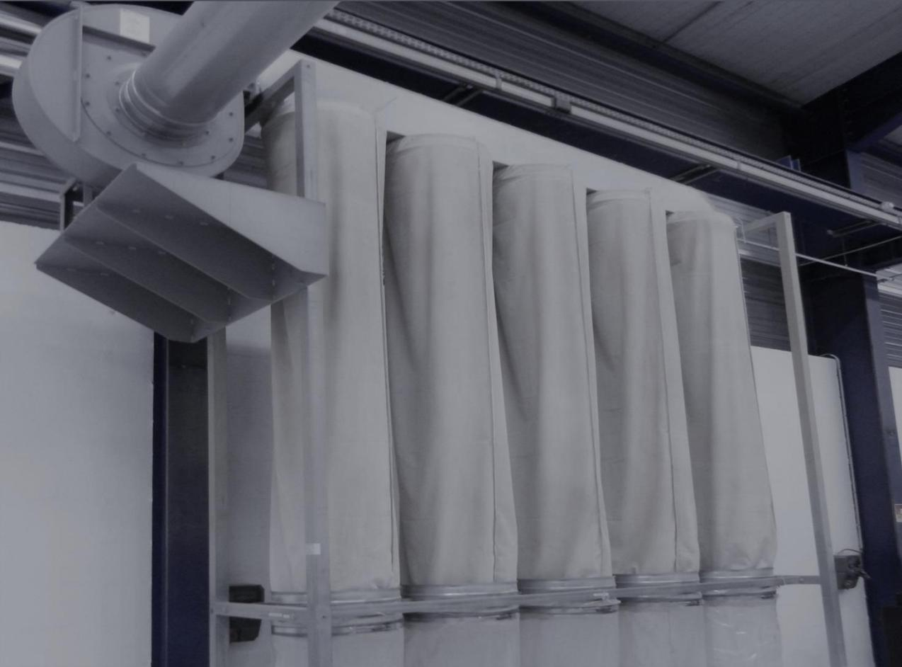
*Les particules et résidus de transformation sont séparés du flux de matière par aspiration tout au long du process.*
